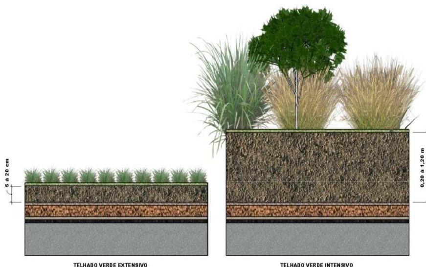
Figura 32 - Comparação entre telhado extensivo e intensivo
