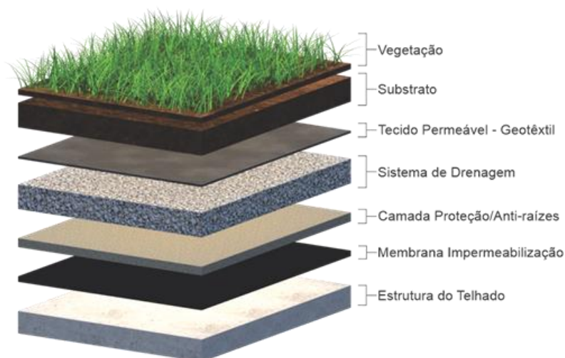
Figura 6 - Estruturas de um telhado verde convencional
